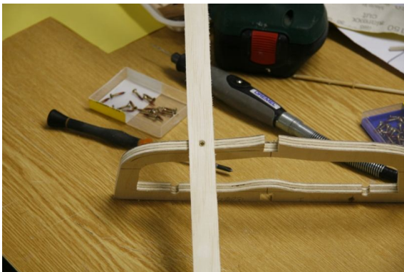
Figuur 5 Schroeven zodat de schroefkop net onder het houtoppervlak ligt...
